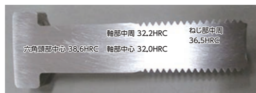
写真2 M16ボルトの硬さ分布
